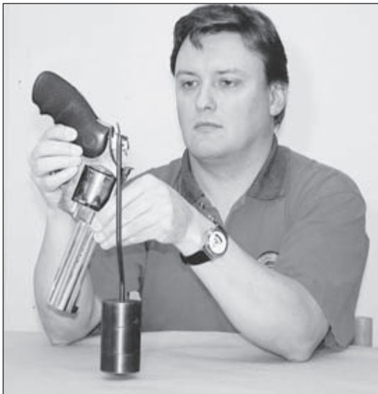
Bild 5: Kontroll av upphakningsmotstånd.
